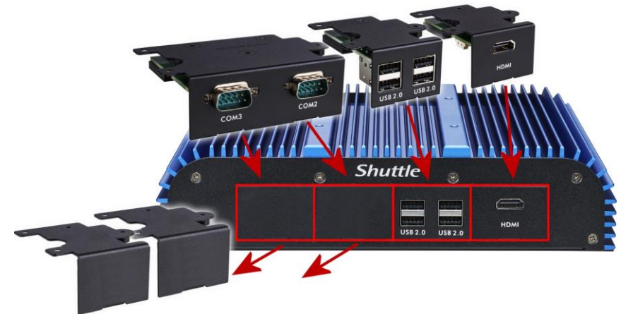
Vorderseite (Beispielkonfiguration) Blindblenden können gegen optionale I/O-Ports ausgetauscht werden
